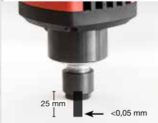
Die MAFELL Fräsmotoren bestehen durch höchste Rundlaufgenauigkeit von < 0,05 mm bei 25 mm Abstand (im Konus < 0,01 mm). Verantwortlich für diese außergewöhnliche Präzision ist die filigrane Abstimmung aller Bauteile und die Tatsache das Anker und Spindel aus einem Stück gefertigt und gewuchtet sind.
