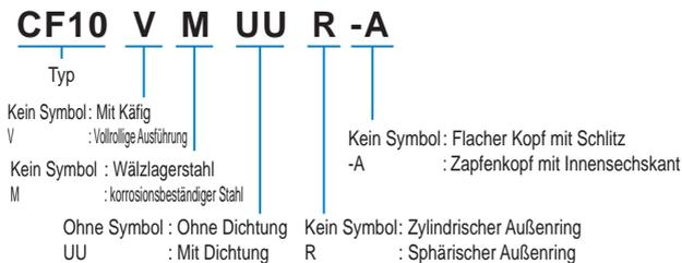
\* Da die Befestigung vom Typ abhängt, entnehmen Sie Einzelheiten aus den Maßstabellen.
