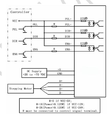
Aufbau mit Open-Collector Signal
