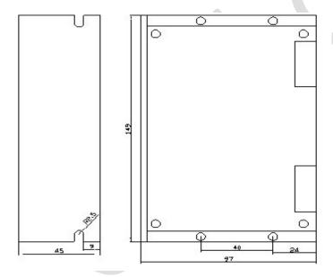
Für eine bessere Wärmeableitung empfehlen wir eine seitliche Montage!
